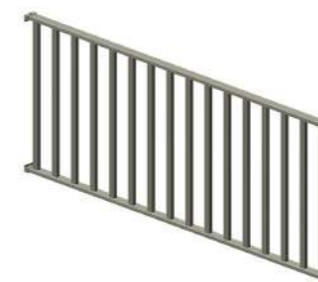
ALUMINIJASTE NAVPIČNE PALICE 32 mm Razmak cca. 95 mm
